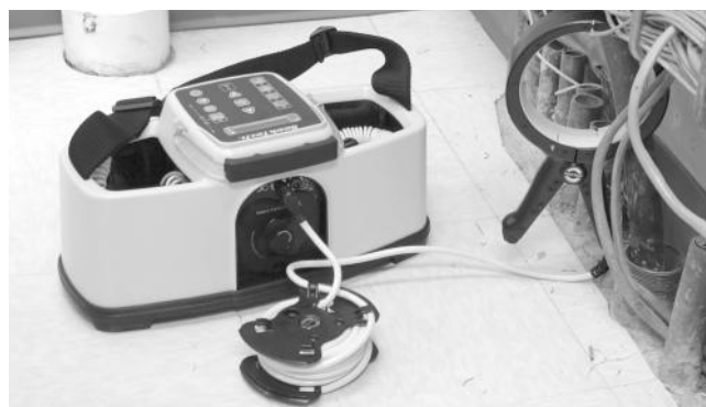
Рис. 12 – индукционный зажим подключен к проводнику
