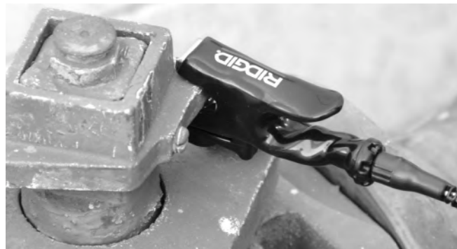
Рис. 8 – подсоединение провода кабеля к целевому проводнику
